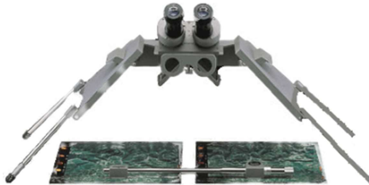
Figura 2. Estereoscopio, principio de la fotogrametría.
